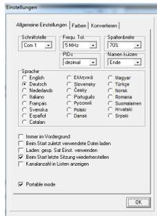
Mit dem Parameter "**Frequ. Tol.**" können Sie eine Toleranz eingeben, die beim Import von anderen Quellen für gleiche Transponder genommen wird. Wenn Sie beispielsweise den Transponder 11721 MHz in Ihren Settings haben und einen Kanal mit der Frequenz 11720 importieren und die Toleranz ist auf 5 MHz eingestellt, so wird kein neuer Transponder angelegt.
